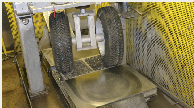
Figur 1. Provningsutrustning enligt modifierad laboratoriemetod prEN 12697-50 "Resistance to Scuffing". Utrustningen finns vid ISAC (Institut für Strassenwesen) i Aachen.
